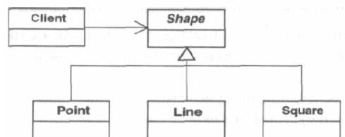
در این شکل می‌توان دید که لفافبندی در سطوح متفاوتی استفاده می‌شود. درست است که از آن برای پنهان‌سازی اطلاعات اشیاء مختلف می‌توان استفاده کرد اما باید به این هم دقت کرد که استفاده‌کننده از نوع شیء خاصی که استفاده می‌کند با
