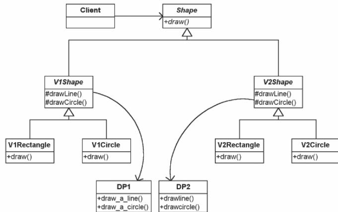
گرچه از میزان چفتشدگی کاسته شده است ولی هنوز مشکل تعدد کلاس‌ها پابرجاست. با مقدم کردن ارث بری برای برنامه‌های نقاشی مختلف افزونگی برای ارتباط به DP1 و DP2 از بین رفت ولی افزونگی وجود دو نوع از مستطیل‌ها و دو نوع از دایره‌ها بر جا مانده است. دقت کنید که هر دو جفت آن‌ها متد draw مشابهی دارند.
